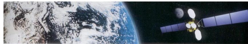
东方红四号卫星平台是中国空间技术研究院研制的新一代大型通信卫星平台，具有大容量、长寿命的特点。平台可用于建造大容量通信广播、视频/音频直播、跟踪与数据中继和区域移动通信等卫星。平台由推进舱、服务舱和太阳能翼构成，承载有效载荷能力595千克，太阳能翼输出功率10500瓦，设计寿命15年。
